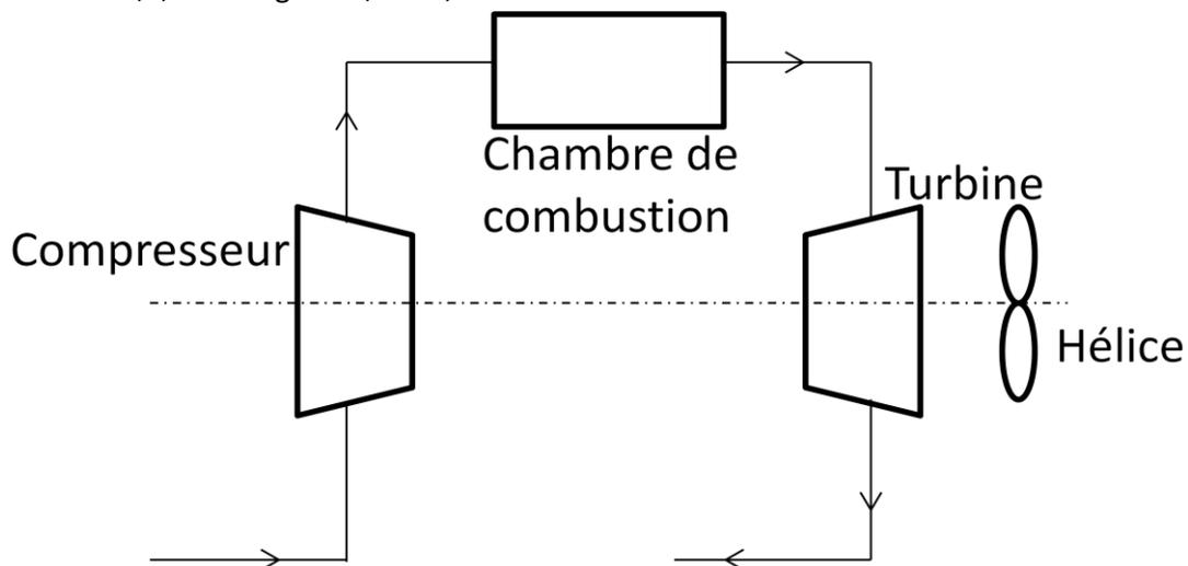
*Première phase* : l'air, à température  $T_0 = 280$  K et à la pression  $P_0 = 1$  bar est aspiré dans le compresseur qui le porte aux conditions  $P_1 = 10$  bar et  $T_1$  par une évolution supposée adiabatique et réversible. On appellera  $w_1'$  le travail fourni par le compresseur à l'unité de masse d'air. Les vitesses d'écoulement seront négligées.
