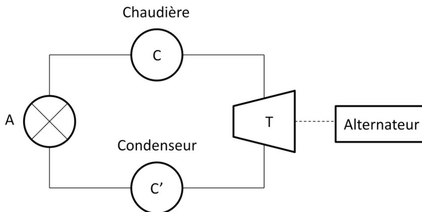
Le fluide utilisé est l'eau, il décrit les cycles suivants :
