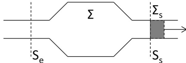
On est en régime permanent : la masse de fluide dans  $\Sigma_s$  est égale à la masse de fluide dans  $\Sigma_e$ .
