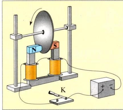
Principe du freinage électromagnétique.
