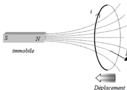
Le courant induit est causé par le déplacement du circuit dans le champ permanent  $\mathbf{B}$ .
