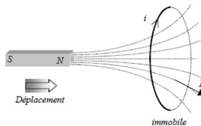
Le champ magnétique n'est plus uniforme mais un champ variable dans le temps :  $\mathbf{B}(t)$ . Ce champ variable engendre un champ électrique variable :  $\mathbf{E}(t)$  qui induit un courant dans les conducteurs de la bobine.
