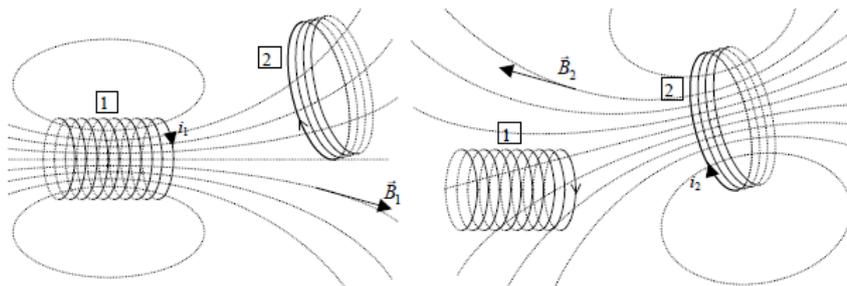
Un couplage par induction mutuelle existe entre deux circuits électriques, lorsque la variation du champ magnétique crée par l'un est sensible dans l'autre.
