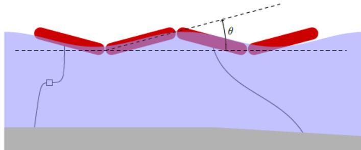
On note  $\theta$  l'angle entre un flotteur et l'horizontale. Il subit de la part de ses voisins deux couples. Un couple de rappel élastique  $-C\theta$  et un couple résistant  $-\beta d\theta/dt$  qui entraîne une génératrice. Sur chaque flotteur s'exerce de plus un couple moteur dû à la houle :  $\Gamma_0 \cos \omega t$ . On note  $J$  le moment d'inertie d'un cylindre par rapport à son centre que l'on supposera fixe.
