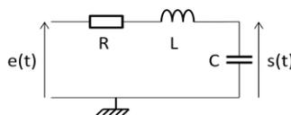
Les tensions  $s(t)$  et  $e(t)$  sont reliées par l'équation différentielle linéaire à coefficients constants :
