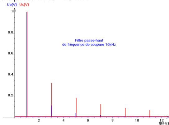
Fréquence de coupure du filtre passe-haut = 1 kHz
