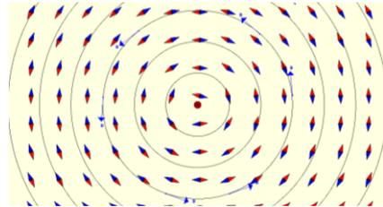
Il y a symétrie de révolution autour de l'axe  $Oz$ , donc le flux élémentaire  $d\phi$  du champ magnétique est le même à travers toute section  $dS$  d'un tube de champ élémentaire :  $d\phi = \vec{B} \cdot d\vec{S}$
