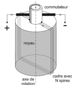
Dans l'entrefer, c'est-à-dire dans l'espace entre les électro-aimants fixes (stator) et la partie mobile (rotor), existe un champ magnétique radial. Placé dans ce champ, le cadre est soumis à un couple de forces de Laplace qui provoquent sa rotation. A chaque demi-tour, le sens du courant dans le cadre est inversé grâce au commutateur. Ainsi le couple agit toujours dans le même sens, et la continuité du mouvement de rotation est assurée !
