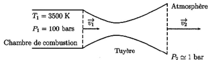
On suppose que le propergol utilisé est composé de  $\text{O}_2$  et  $\text{H}_2$ , les gaz brûlés sont de la vapeur d'eau, considérée comme un gaz parfait, de masse molaire  $M$  et d'exposant adiabatique  $\gamma = 1,30$ .
