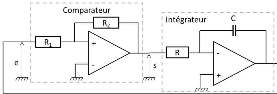
Supposons un bruit dans notre montage comparateur. Ce faible signal est légèrement positif. La sortie du comparateur est alors égale à :  $s = +V_{sat}$ . L'intégrateur va alors intégrer cette valeur et
