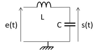
Son équation différentielle se met sous la forme suivante, ce qui donne une tension aux bornes du condensateur sinusoïdale.
