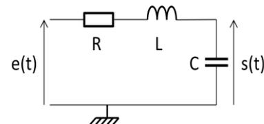
Son équation différentielle se met sous la forme suivante, ce qui donne une tension aux bornes du condensateur qui dépend de la valeur des composants choisis. Cependant, pour une résistance faible, on peut supposer le facteur de qualité du circuit suffisamment important pour que l'on se trouve en régime pseudo-périodique.
