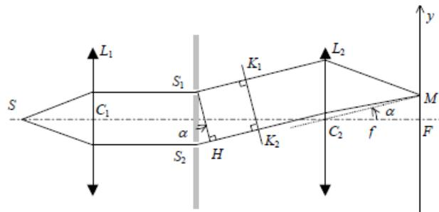
Pour pouvoir se ramener à une distance finie, on place une seconde lentille convergente  $L_2$  telle que l'écran se trouve en son plan focal image.
