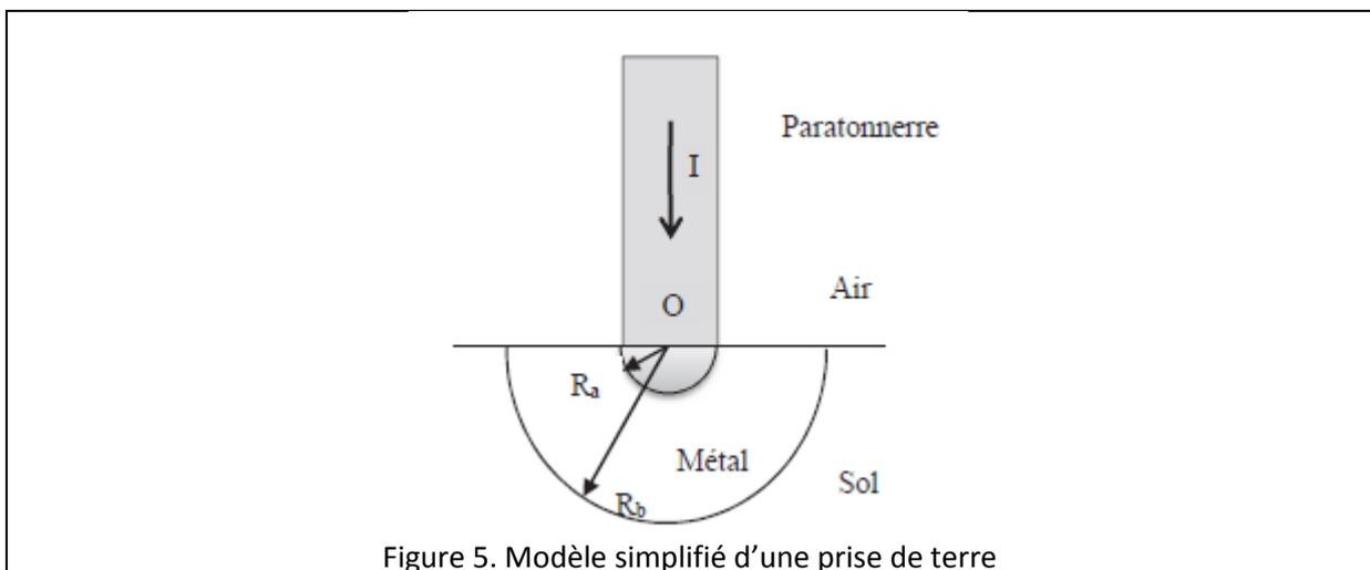
Figure 5. Modèle simplifié d'une prise de terre
