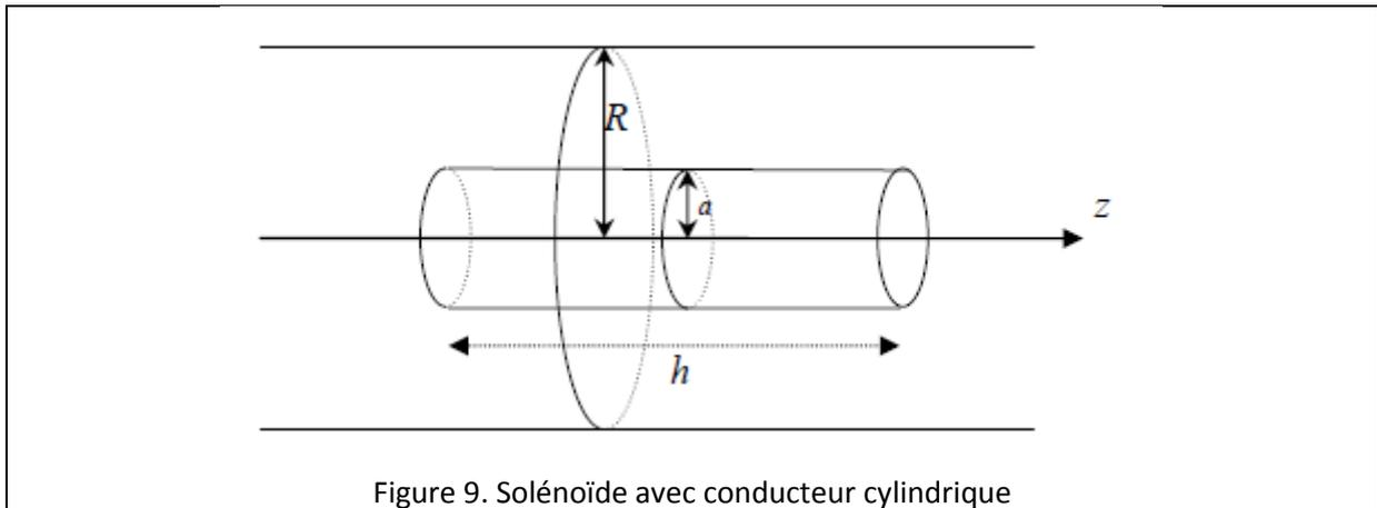
Figure 9. Solénoïde avec conducteur cylindrique
