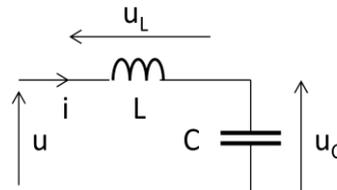
3) Donner l'équation différentielle vérifiée par la tension aux bornes d'un condensateur dans un circuit RLC. La résoudre en supposant que le condensateur est initialement déchargé. La tension appliquée en entrée est un échelon variant entre 0 et  $E$ .
