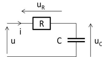
2) Donner l'équation différentielle vérifiée par la tension aux bornes d'un condensateur dans un circuit LC. La résoudre en supposant que le condensateur est initialement déchargé. La tension appliquée en entrée est un échelon variant entre 0 et  $E$ .
