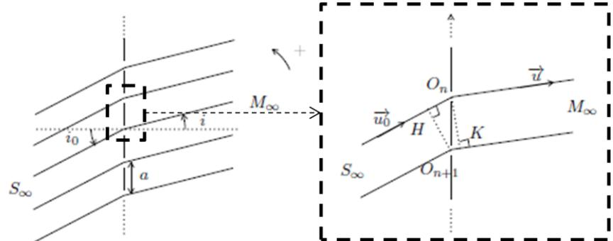
Pour que la lumière diffractée dans une direction  $i$  soit observable, il faut que les interférences entre les ondes issues de deux motifs successifs soient constructives.
