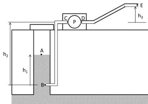
Le diamètre de la canalisation envisagé par le concepteur dans le circuit d'aspiration est soit  $d_1 = 40\text{mm}$ , soit  $d'_1 = 50\text{mm}$ .
