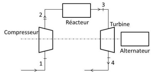
L'air subit alors une transformation isobare au cours de laquelle il reçoit un transfert thermique portant sa température à la valeur  $T_3 = 1260 \text{ K}$ ; une détente dans une turbine calorifugée ramène finalement la pression du gaz à la valeur  $P_4 = 1 \text{ bar}$ . Le travail récupéré dans la turbine sert à entrainer le compresseur ainsi que l'alternateur, ces trois machines étant montées sur le même arbre de transmission.
