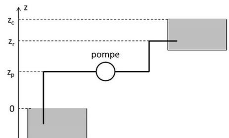
La conduite de refoulement qui emmène l'eau de la pompe au château d'eau est de longueur  $L_r = 3,2km$  et de diamètre  $D_r = 0,20m$ . Elle comporte deux coudes pour lesquels la perte de charge singulière totale a pour coefficient  $\alpha_r = 2,25$ . L'arrivée de cette conduite est à une altitude  $z_r = 240m$ . Dans le château d'eau, la surface
