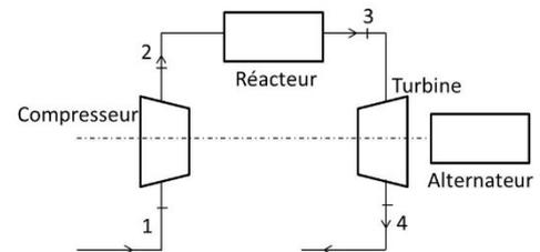
L'air subit alors une transformation isobare au cours de laquelle il reçoit un transfert thermique portant sa température à la valeur  $T_3 = 1260K$ ; une détente dans une turbine calorifugée ramène finalement la pression du gaz à la valeur  $P_4 = 1bar$ . Le travail récupéré dans la turbine sert à entrainer le compresseur ainsi que l'alternateur, ces trois machines étant montées sur le même arbre de transmission.
