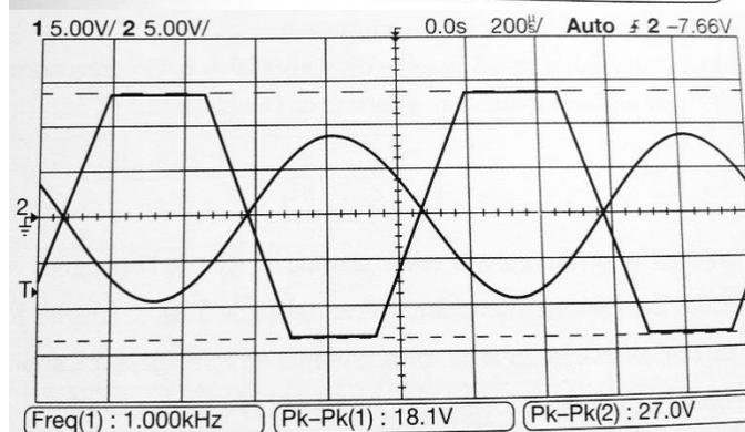
c) Avec les mêmes signaux, mais en sélectionnant le mode XY, le manipulateur obtient la trace représentée à la figure suivante. Expliquer. Quelle propriété de l'opérateur peut-on déduire de l'indication des curseurs :  $\Delta X = 12,4V$  et  $\Delta Y = 27,2V$  ?
