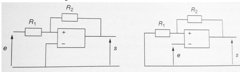
2) Les valeurs de résistances utilisées sont  $R_1 = 33k\Omega$  et  $R_2 = 68k\Omega$ . Les observations sont-elles cohérentes avec ce choix, sachant que l'amplitude crête à crête mesurée en sortie est égale à 27,2 V ?
