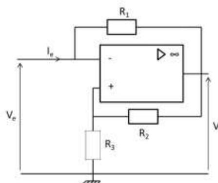
4) Montrer qu'en régime linéaire, on obtient la relation suivante entre la tension d'entrée  $V_e$  et le courant d'entrée  $I_e$  :  $I_e = -\frac{V_e}{R'}$ . On exprimera  $R'$  en fonction de  $R_1$ ,  $R_2$  et  $R_3$ .
