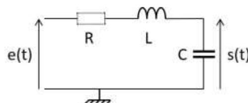
**1)** Montrer que l'équation différentielle vérifiée par la tension de sortie est :  $\ddot{s} + \frac{\omega_0}{Q} \dot{s} + \omega_0^2 s = 0$ . On exprimera la pulsation propre, ainsi que le facteur de qualité en fonction de  $R$ ,  $L$  et  $C$ . Quelle est la forme de la solution homogène pour une valeur de résistance suffisamment faible ?
