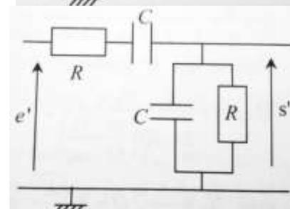
3) a) On couple le filtre de Wien avec le montage amplificateur du 1. A partir des expressions  $\underline{F}$  et  $\underline{G}$ , montrer qu'il peut théoriquement exister un signal sinusoïdal sans générateur basse fréquence pour une valeur  $r = \frac{R_2}{R_1}$  et une fréquence  $f$  particulière à déterminer.
