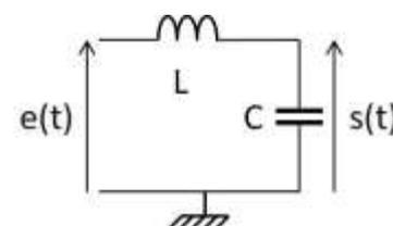
$$\ddot{s} + \omega_0^2 s = 0 \quad \Rightarrow \quad s(t) = A \cos(\omega_0 t) + B \sin(\omega_0 t) \quad \text{avec} \quad \omega_0 = \frac{1}{\sqrt{LC}}$$
