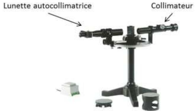
Utilisé avec un réseau, il permet de mesurer avec précision des longueurs d'onde. C'est l'objectif de ce TP.
