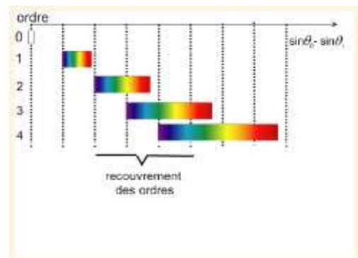
Un réseau peut donc être utilisé en tant que spectromètre ou spectroscopie, c'est-à-dire pour mesurer les longueurs d'onde composant un rayonnement.
