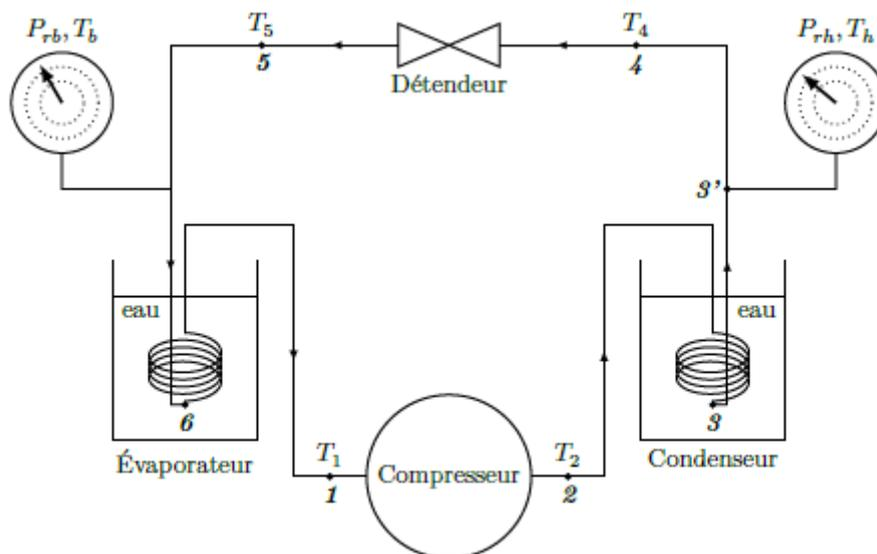
Figure 5 Schéma d'ensemble de la pompe à chaleur
