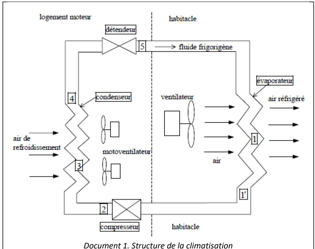
Pour refroidir l'air intérieur du véhicule, un fluide frigorigène effectue en continu des transferts énergétiques entre l'intérieur, l'extérieur du véhicule et le compresseur. Le fluide frigorigène utilisé depuis 1995, en remplacement du fréon utilisé jusqu'alors est du tétrafluoroéthane, connu sous l'appellation R134A.
