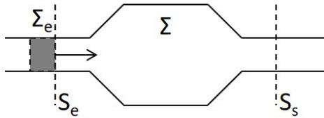
Instant  $t$ Système  $\Sigma$  ouvert+ masse  $\delta m$  dans  $\Sigma_e$  de fluide pénétrant dans  $\Sigma$  pendant  $dt$
