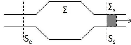
Instant  $t + dt$ Système  $\Sigma$  ouvert+ masse  $\delta m$  dans  $\Sigma_s$  de fluide sortant de  $\Sigma$  pendant  $dt$ A l'instant  $t$ , l'énergie totale du système  $\Sigma'$  est :
