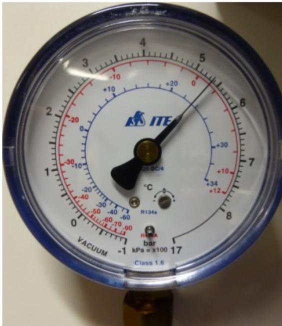
Manomètre basse pression ( $P_{rb}$ )
