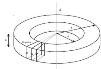
1) Lorsqu'un courant d'intensité I parcourt le circuit, déterminer le flux du champ magnétique propre à travers l'une des spires. En déduire une expression de l'inductance propre du bobinage.
