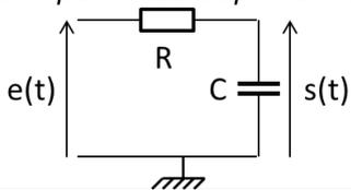
$$\underline{H} = \frac{s}{e} = \frac{1}{1+jRC\omega} = \frac{1}{1+j\frac{\omega}{\omega_c}} \text{ avec } \omega_c = \frac{1}{RC} \text{ la pulsation de coupure.}$$
