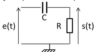
$$\underline{H} = \frac{s}{e} = \frac{jRC\omega}{1+jRC\omega} = \frac{j\frac{\omega}{\omega_c}}{1+j\frac{\omega}{\omega_c}} \text{ avec } \omega_c = \frac{1}{RC}$$
