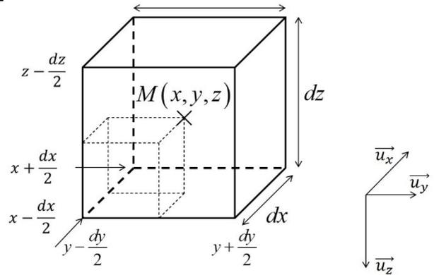
Principe fondamental de la dynamique :  $d\vec{F}_V + d\vec{F}_S = \vec{0}$
