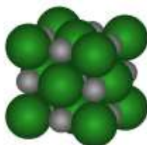
FIGURE 11 : REPRÉSENTATION 3D DU RESEAU CRISTALLIN DU CHLORURE DE SODIUM
