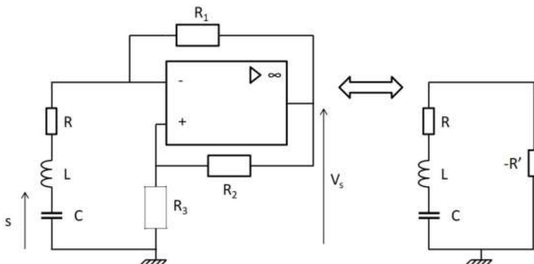
7) Donner la nouvelle équation différentielle vérifiée par la tension  $s(t)$ . Quelle est la forme de la solution  $s(t)$  dans les trois cas suivants :  $R > R'$ ,  $R = R'$  et  $R < R'$ ? Accompagner chacun des cas d'un tracé de la fonction  $s(t)$  en fonction du temps. Dans quel cas a-t-on réalisé un oscillateur? Dans quel cas peut-on considérer cet oscillateur comme quasi-sinusoïdal?
