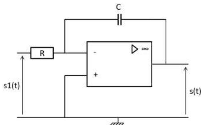
**3) L'ALI étant supposé en régime linéaire et idéal, montrer que l'entrée et la sortie sont reliées par l'équation différentielle suivante :  $s1(t) = -RC \frac{ds}{dt}(t)$ . En déduire l'expression de la fonction de transfert :  $\underline{I}(j\omega) = \frac{s}{s1}$ .**
