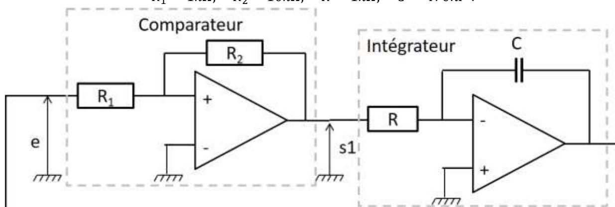
6) Réaliser le montage précédent et observer les signaux  $s(t)$  et  $e(t)$ . Pour rappel, le GBF n'est plus ici branché au circuit. Commenter leur forme. Retrouver en particulier les valeurs de la tension de saturation de l'ALI et des deux tensions de seuil du montage comparateur.
