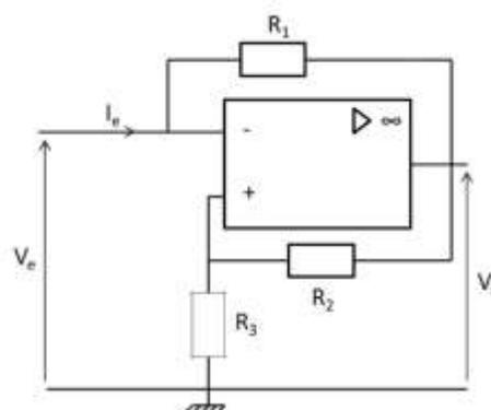
6) Montrer qu'en régime linéaire, on obtient la relation suivante entre la tension d'entrée  $V_e$  et le courant d'entrée  $I_e$  :  $I_e = -\frac{V_e}{R'}$ . On exprimera  $R'$  en fonction de  $R_1, R_2$  et  $R_3$ .
