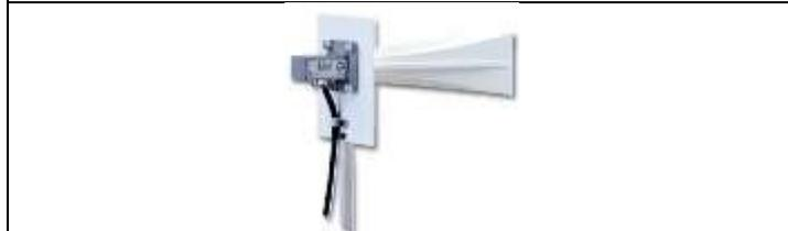
Oscillateur à diode Gunn avec cavité résonnante et antenne cornet
