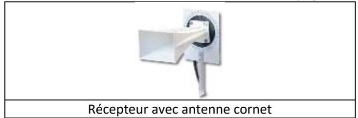
Récepteur avec antenne cornet
