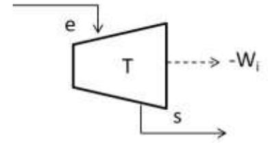
La conception d'une turbine est totalement orientée vers la récupération maximale d'énergie utile, au détriment de l'énergie cinétique du fluide, on peut donc la négliger. On pourra de plus négliger l'énergie potentielle de pesanteur du fluide. Le régime est supposé stationnaire.
