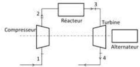
L'air subit alors une transformation isobare au cours de laquelle il reçoit un transfert thermique portant sa température à la valeur  $T_3 = 1260 \text{ K}$ ; une détente dans une turbine calorifugée ramène finalement la pression du gaz à la valeur  $P_4 = 1 \text{ bar}$ . Le travail récupéré dans la turbine sert à entraîner le compresseur ainsi que l'alternateur, ces trois machines étant montées sur le même arbre de transmission.
