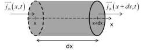
On étudie toujours un modèle unidimensionnel selon  $(Ox)$ , la température ne dépend donc que de  $x$  et  $t$  :  $T(x, t)$ . On considère un petit volume compris entre les abscisses  $x$  et  $x + dx$  de section  $\Sigma$ .
