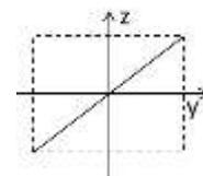
Mise en évidence d'une polarisation rectiligne :
