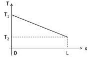
**Définition** : résistance thermique  $R_{th}$  (en  $K.W^{-1}$ )
