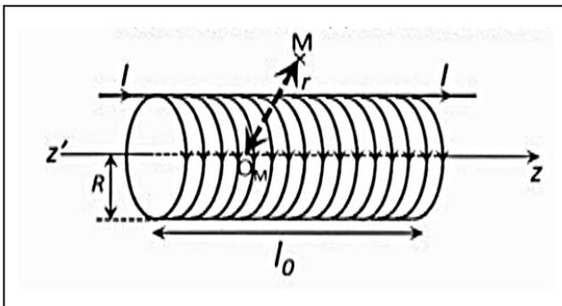
Figure 8. Solénoïde de longueur  $l_0$  constitué de  $N$  spires jointives bobinées sur un cylindre rempli d'air, dans lesquelles circule un courant électrique d'intensité  $I$
