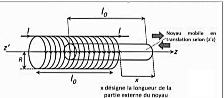
Figure 9. Capteur magnétique à insertion d'un noyau au sein du solénoïde de la Figure 8 initialement rempli d'air.
