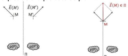
**Plan d'anti-symétrie  $\Pi^*$**  = plan de symétrie géométrique et charges opposées de chaque côté du plan  $\Pi^*$ .
