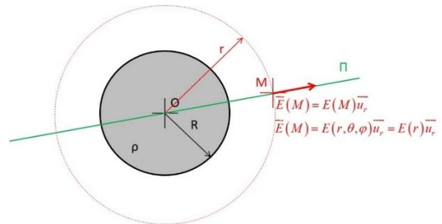
Flux :  $\oiint_{\Sigma} \vec{E} \cdot \vec{dS} = \oiint_{\Sigma} E(r) \vec{u}_r \cdot dS \vec{u}_r = \oiint_{\Sigma} E(r) dS = E(r) \oiint_{\Sigma} dS = E(r) 4\pi r^2$
