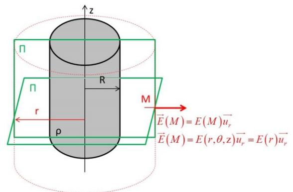
Flux :  $\oiint_{\Sigma} \vec{E} \cdot \vec{dS} = \iint_{latérale} E(r) \vec{u}_r \cdot dS \vec{u}_r + \iint_{transversales} E(r) \vec{u}_r \cdot dS \vec{u}_z = \iint_{latérale} E(r) dS = E(r) 2\pi r h$
