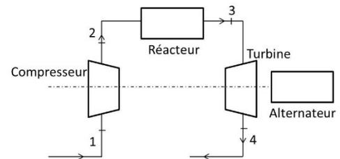
L'air subit alors une transformation isobare au cours de laquelle il reçoit un transfert thermique portant sa température à la valeur  $T_3 = 1260K$ ; une détente dans une turbine calorifugée ramène finalement la pression du gaz à la valeur  $P_4 = 1bar$ . Le travail récupéré dans la turbine sert à entraîner le compresseur ainsi que l'alternateur, ces trois machines étant montées sur le même arbre de transmission.
